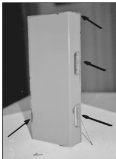
Pulverabplatzungen an unter Sauerstoff geschnittenen Laserkanten nach 100 h Salzsprühnebel-Beanspruchung.
