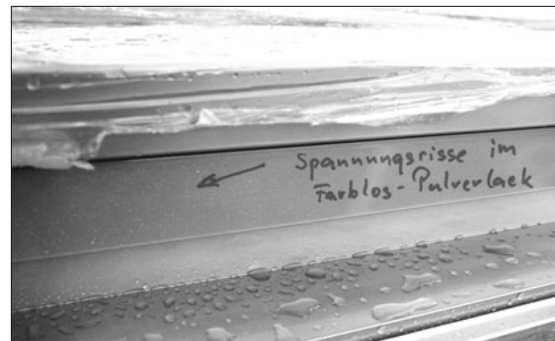
Spannungsrisse bei farblosen Überbeschichtungen von Metallic-Effektpulverlacken.
