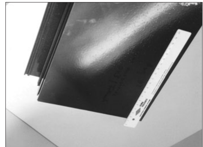
Oberflächenstörungen im Pulverlackfilm infolge von Fettrückständen auf dem Alu-Profil.
