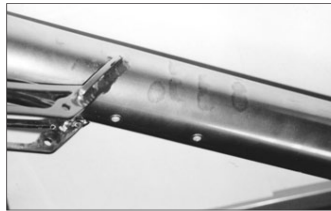
Fettrückstände auf gestrahlten Fahrradrahmen unter einem Metallic-Pulverlack.
