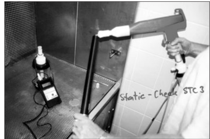
Das Aufladungsverhalten des Beschichtungsgeräts sollte mit einem Static-Check „STC 3“ regelmäßig überprüft werden.
