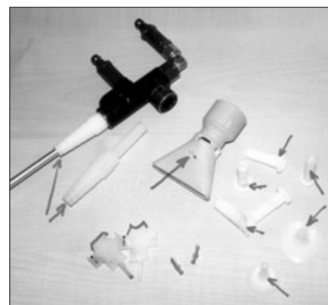
Verschleißelemente an der Sprüheinheit (Pistole und Injektor). Quelle (zwei Fotos): Dr. Herrmann
