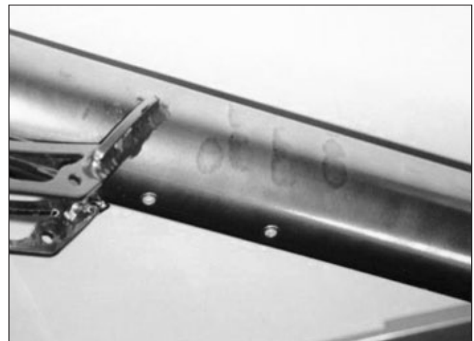
Fehlerbild Fingerabdrücke: Nicht beständige Effekt-Pulver verlieren ihren Glanz und verfärben sich meist schwarz.
