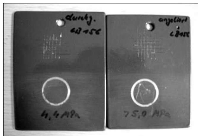
Laborprüfresultate zum Pulververbund zwischen Grundier- und Deckbeschichtung in Abhängigkeit der Einbrennbedingungen der Grundierung: Das rechte Musterblech ist nur angeliert, das linke durchgetrocknet.
