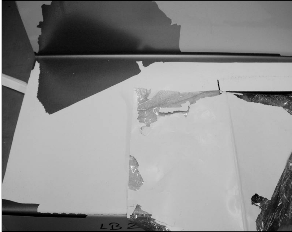
Das Bild zeigt einen Schadensfall aufgrund ungenügender Vorbehandlung: Der Pulverlack enthaftet sich infolge mangelnder Beizentfettung und nachfolgender Gelb-Chromatierung auf einem Aluminiumsubstrat.
