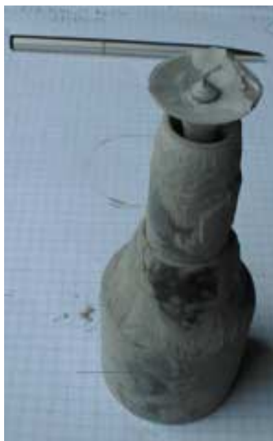
Metallicpulver sintert an einem Teil des Pralltellers an. Der Grund dafür ist eine verbogene Elektrodenadel.
