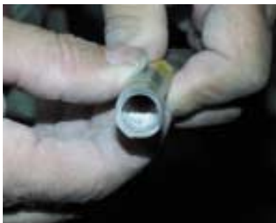
Ablagerungen an der Applikationstechnik können durch regelmäßiges Reinigen vermieden werden.
