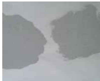
Verschiedene Effekte bei Rückgewinnungspulver. Rechts: Frischpulver; links: mit Zyklon zurückgewonnenes Pulver.
