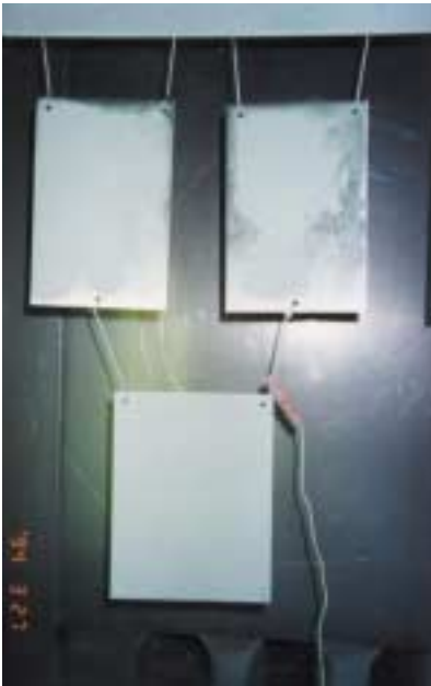
Beschichtungsanlage und Werkstück müssen ausreichend geerdet sein, damit der Effekt gleichmäßig ist
