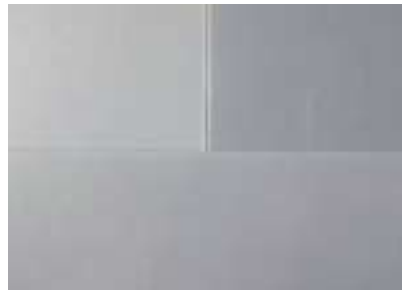
Farbtonschwankungen des gleichen Pulverlacks durch unterschiedliche Applikationstechnik
