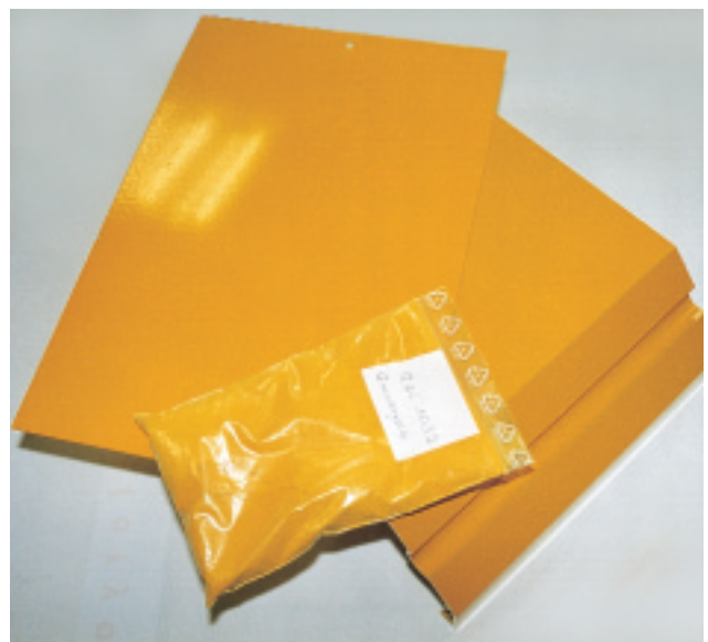
Mit einer Pulvereingangskontrolle können unterschiedliche Qualitäten, zum Beispiel hinsichtlich Farbton und Deckkraft, frühzeitig erkannt werden
