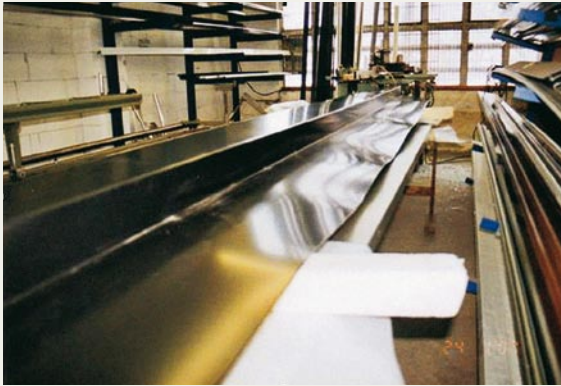
Bild 5: Verformungen nach dem Pulvereinbrennprozess als Folge von inneren Materialspannungen
