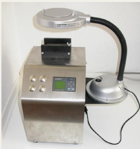
Bild 4: Um die Ursache für die Spannungsrisse herauszufinden, wurde ein spezielles Prüfgerät entwickelt
